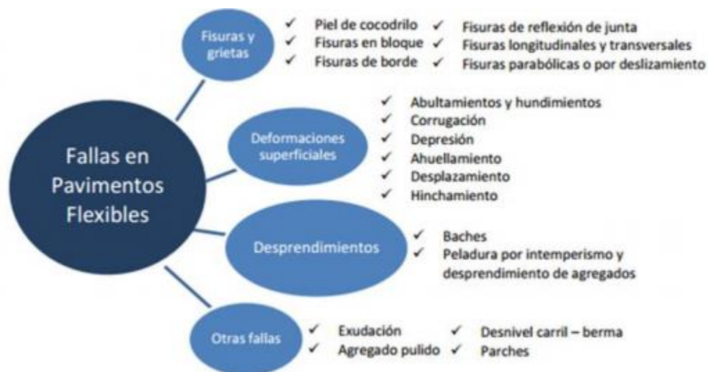
Figura 1. Fallas en pavimentos flexibles
