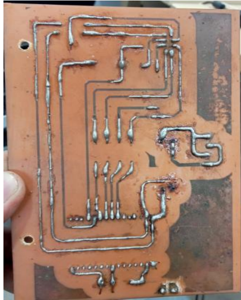
Figura 65. Presencia De Corrosión En PCB.
