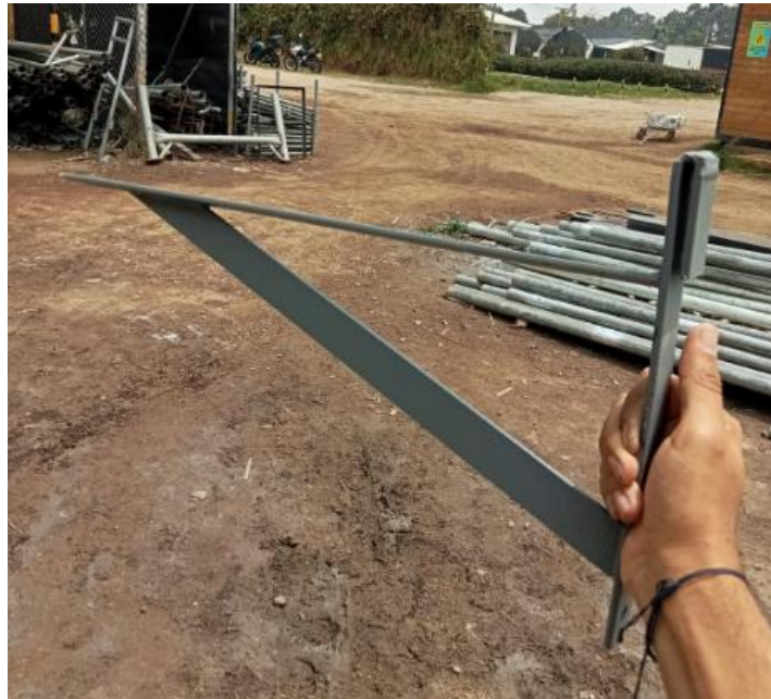
Figura 50. Soporte Del Panel Solar.
