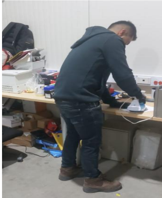
Figura 57. Proceso De Planchado Del Circuito.
