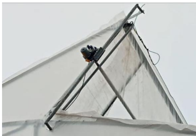
Figura 55. Correcta Alineación Del Motor Y Carril Guía.
