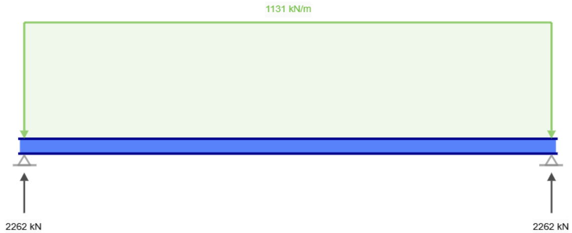
Figura 14. Diagrama De Cuerpo Libre Del Eje.
