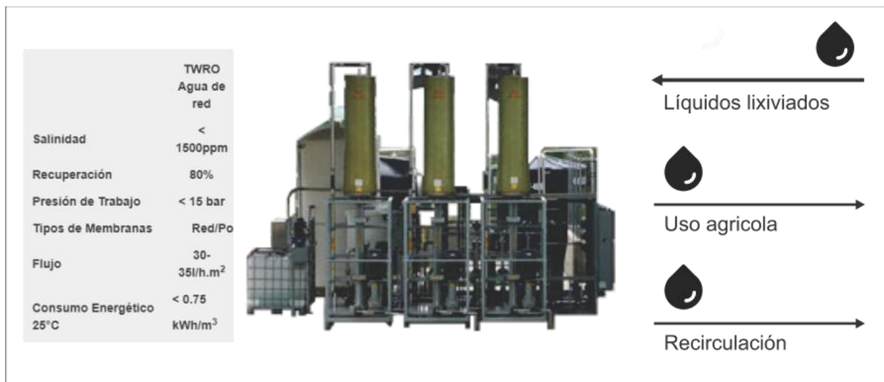
Figura 31. Maquina tratamiento lixiviado Fuente PROACTIVA VALLE DEL CAUCA
