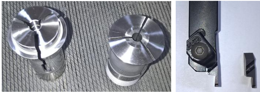
Figura 6-2: Herramientas adquiridas. Izq, pinzas de sujeción de materia prima de 1/4". Der, inserto de 1.5 para tronzado ref
