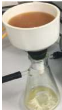
Figura 7. Proceso de filtración mediante bomba de vacío.
