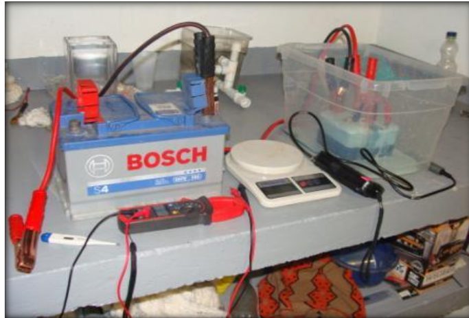
Figura 8. Montaje experimental del proceso de electrocoagulación
