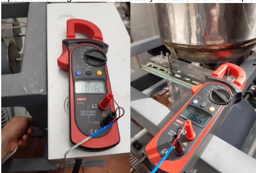
Figura 51. Temperatura del agua de las cubetas y de la cera en el tanque
