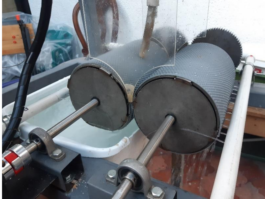
Figura 47. Sistema de refrigeración final
