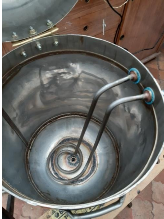
Figura 27. Tanque de cera con resistencia eléctrica
