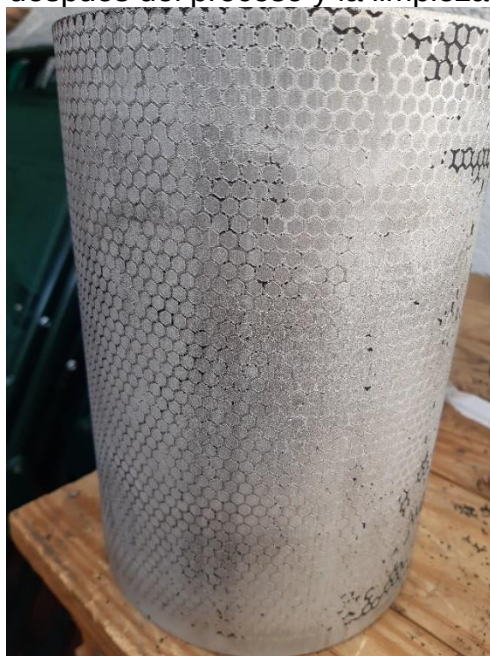
Figura 36. Rodillo grabado después del proceso y la limpieza de la tinta
