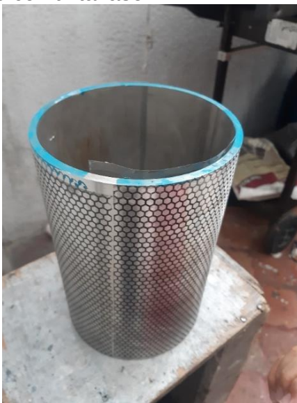
Figura 34. Rodillo estampado con tinta laser
