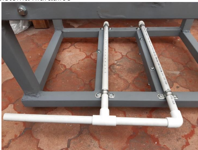
Figura 28. Anclaje sistema hidráulico
