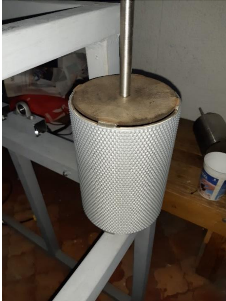
Figura 42. Grabado acoplado al cilindro
