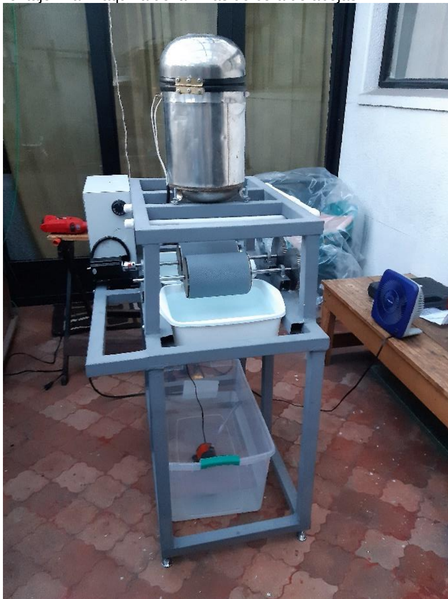
Figura 44. Montaje final máquina de láminas de cera de abejas
