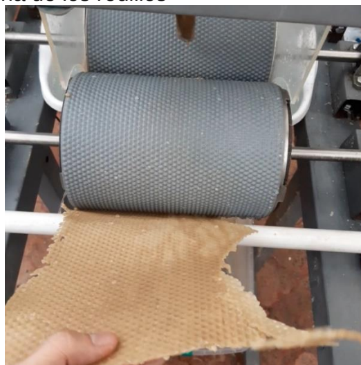
Figura 52. Retirando lámina de los rodillos
