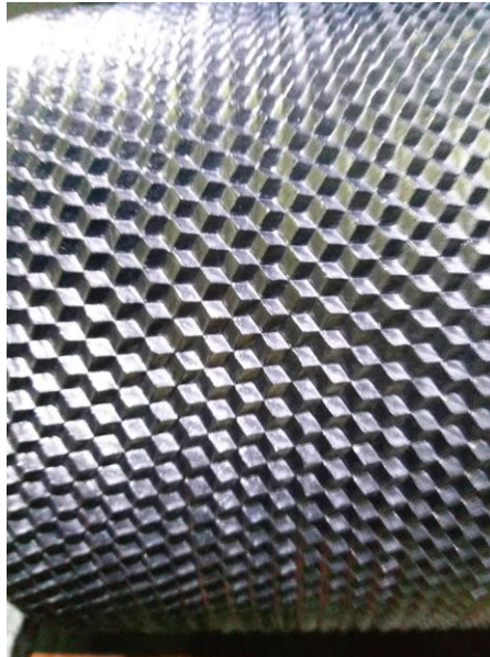
Figura 37. Rodillo grabado mecanizado CNC
