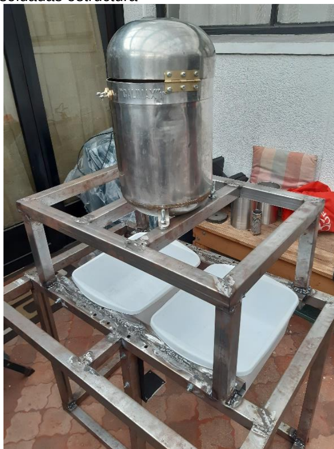
Figura 26. Uniones soldadas estructura
