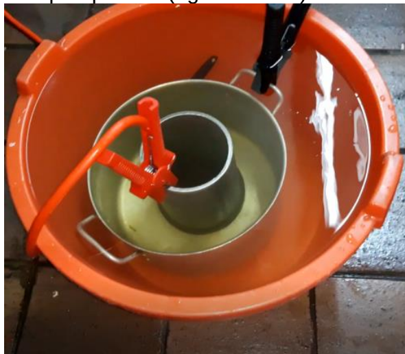
Figura 35. Experimento ataque químico (agua con sal) con 24 V
