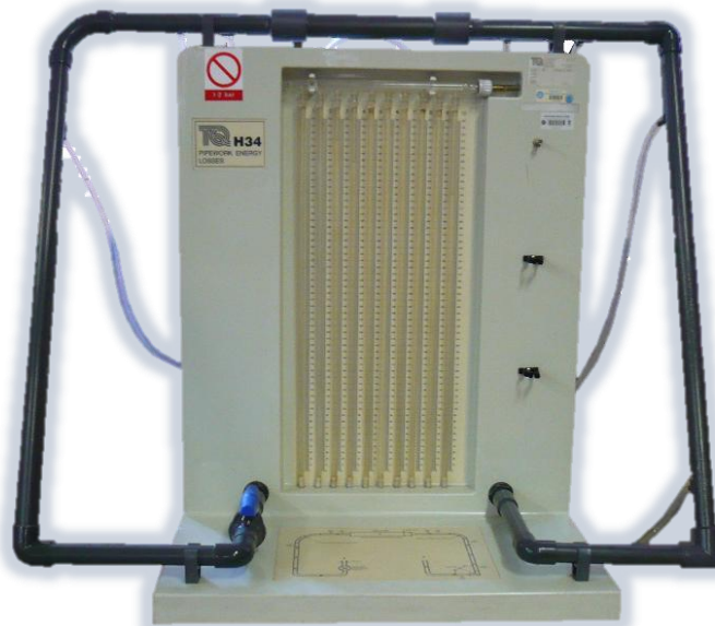
Fig. 1 Aparato para determinar pérdidas de energía por accesorios (H34)
