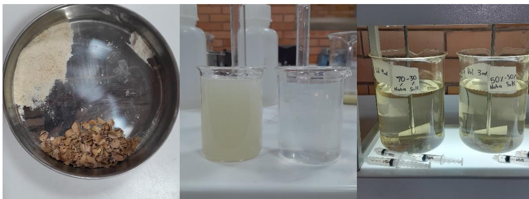
Figura 33. Preparación solución de haba y sulfato.
