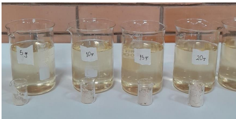
Figura 2. Jarras para aplicación directa del coagulante de haba.
