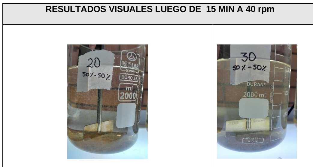
Figura 26. 15min de test de jarras a 40 rpm
