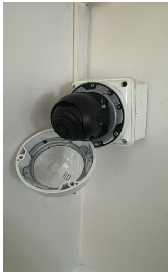
Figura 6.8: Cámara tipo domo sin su cubierta de protección.
