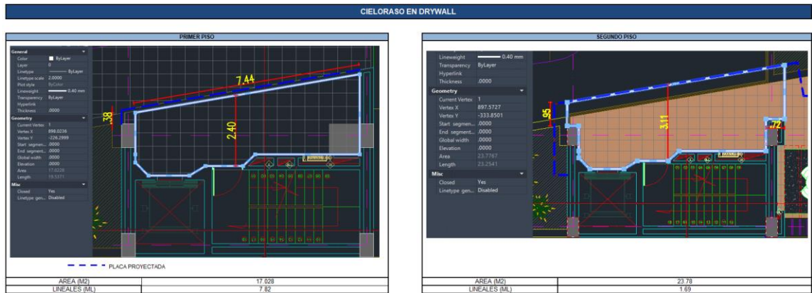
Figura 18. Memorias de los adicionales – Cielo raso
