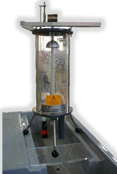
Fig. 1 Montaje experimental impacto de chorro
