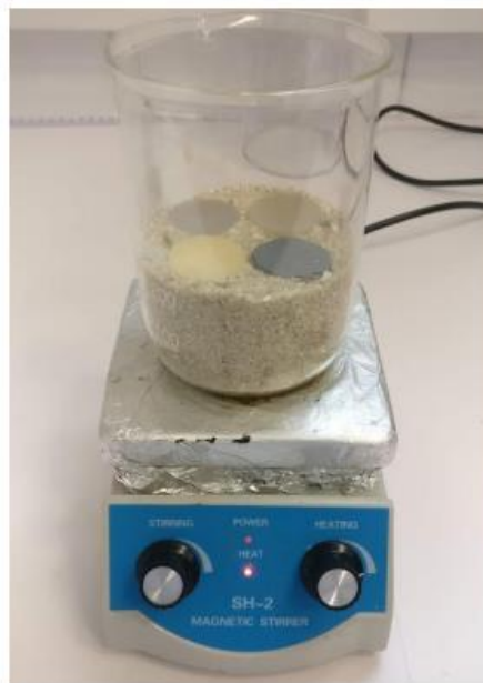
Fotografía 3. Vaso de precipitado con arena y probetas
