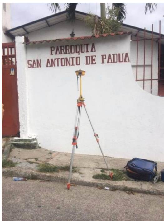
Figura 6. GPS HI TARGET modelo V60 llamado Base ubicado en la placa Montecarlo 1 Fuente: Alexander Gutiérrez.
