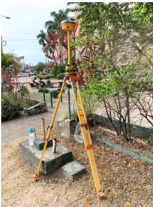
Figura 4. GPS ubicado en la placa GPS B2-E-2 Fuente: Autores.
