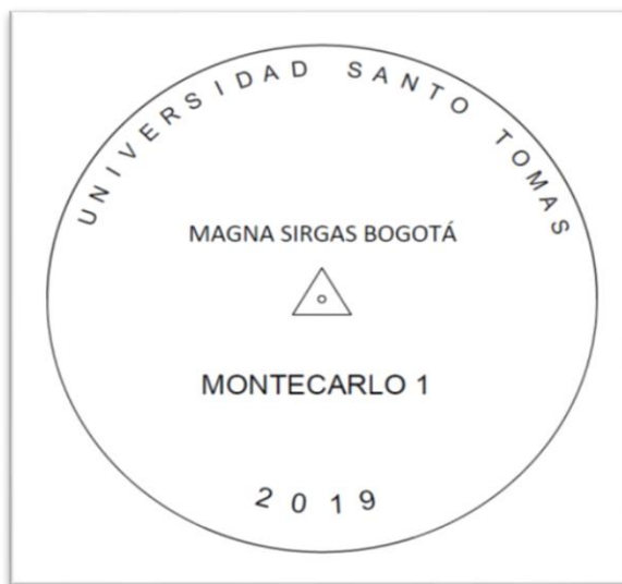
Figura 23. Nomenclatura de un mojón Fuente: Autores.
