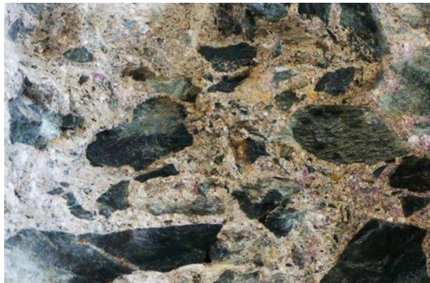
Imagen 22. Detalle los agregados gruesos de tipo ígneo presentes en la mezcla. Fuente: Autor.
