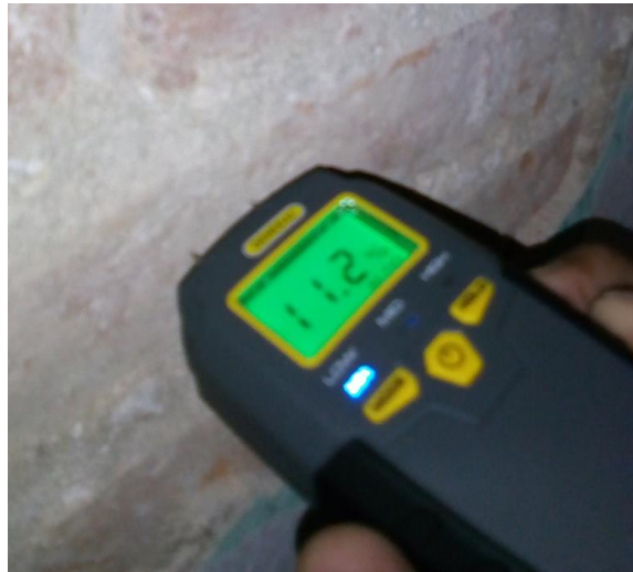
Imagen 65. Uso de Humedometro digital. Su uso complementa los resultados de la esclerometría. Fuente: Autores.
