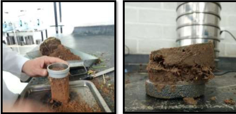
Figura 3-31. Preparación de muestra y resultado del corte directo. Fuente: Autor
