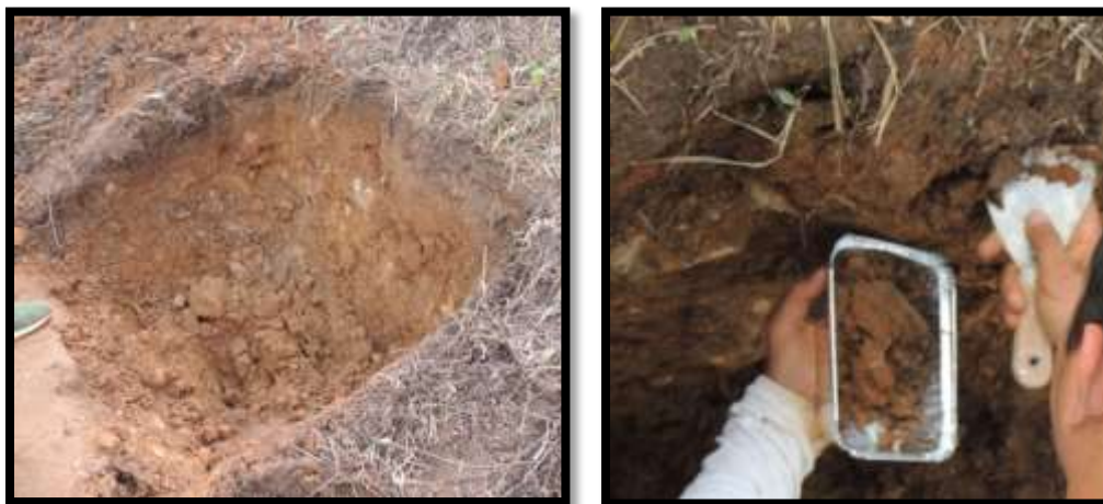
Figura 3-5. Apiques y toma de muestras. Fuente: Autor
