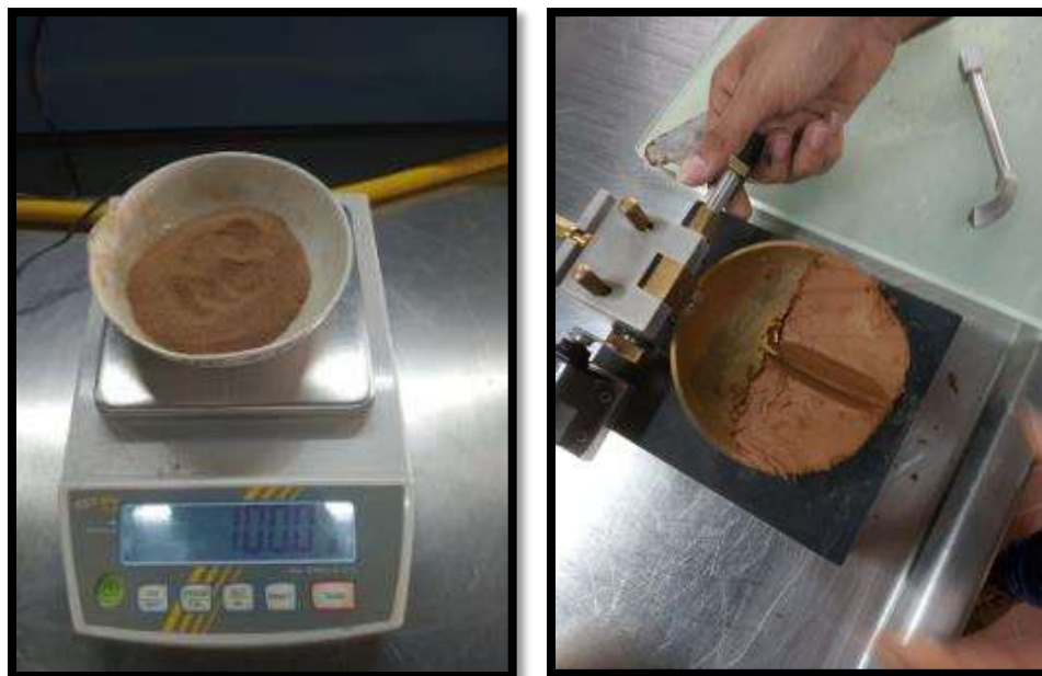
Figura 3-22. Preparación y ensayo de límite líquido. Fuente: Autor
