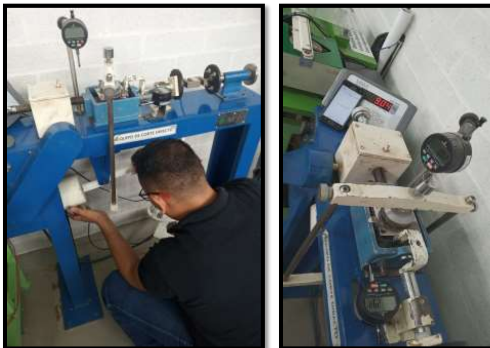
Figura 3-26. Equipo de corte directo, facilitado por la Universidad Cooperativa de Colombia. Fuente: Autor
