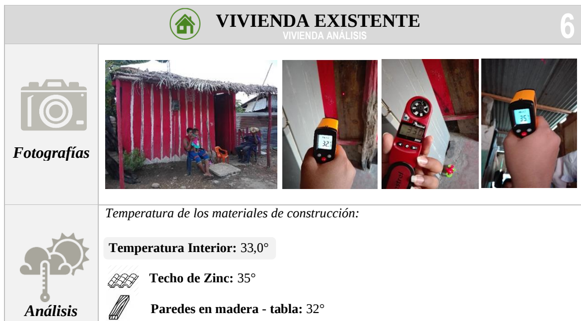
Figura 150. Análisis temperatura interior de vivienda existente 6
