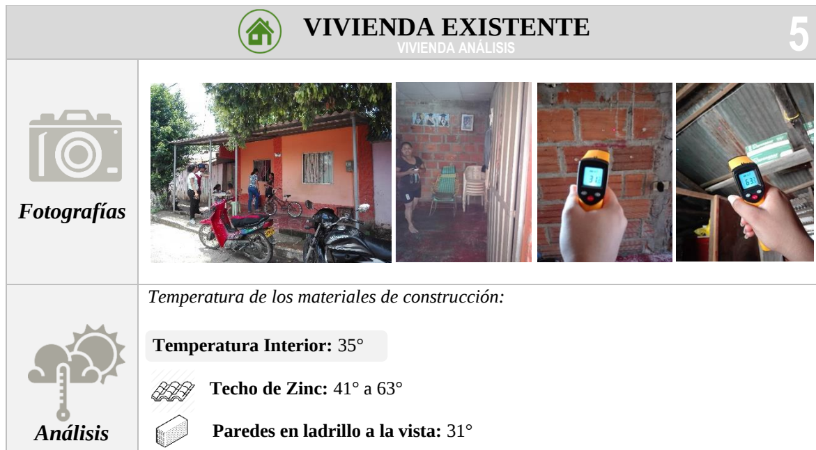
Figura 149. Análisis temperatura interior de vivienda existente 5
