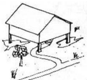
Figura 49. Vivienda con pilotes en zona de inundación Fuente: Manual del Arquitecto Descalzo
