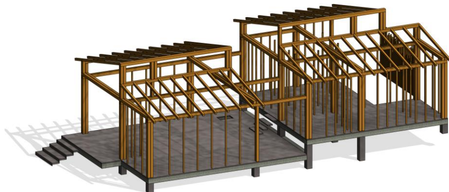
Figura 78. Entramado vigas y columnas en madera
