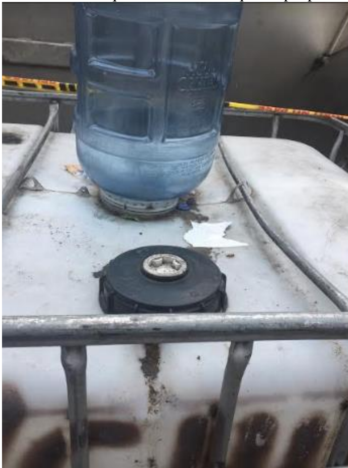
Apéndice K. Isotank de 1 m3 con boquilla apta para botellón
