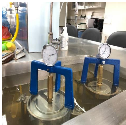
Figura 18. Muestra Sumergida para ensayo CBR en el laboratorio
