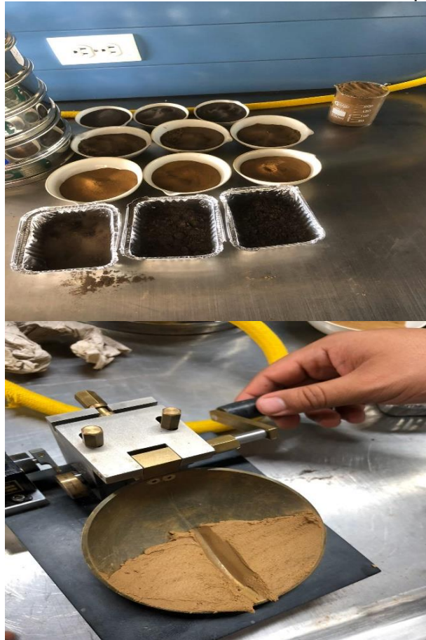
Figura 8. Muestra de suelos extraídos en los apiques.
