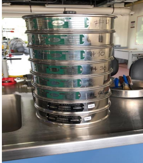
Figura 9. Tamices utilizados para realizar la granulometría del suelo.
