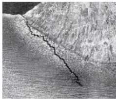
GRIETAS DE BORDE
