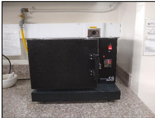
Fig. 10 HORNO A 375° EN ENSAYO DE IGNICIÓN.
