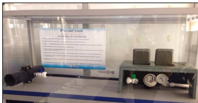
Figura 8. Esquema de conexión de acometida de acueducto
