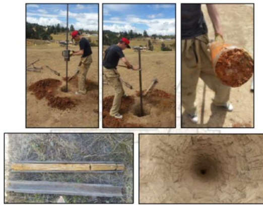
Figura 6. Ejecución de sondeos en el predio del proyecto, sondeo 1
