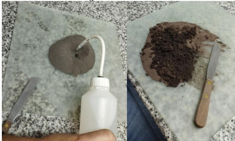
Figura 27. Ensayo de límites de Atterberg
