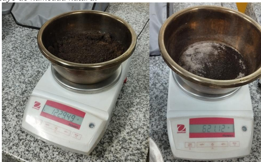
Figura 24. Ensayo de humedad natural
