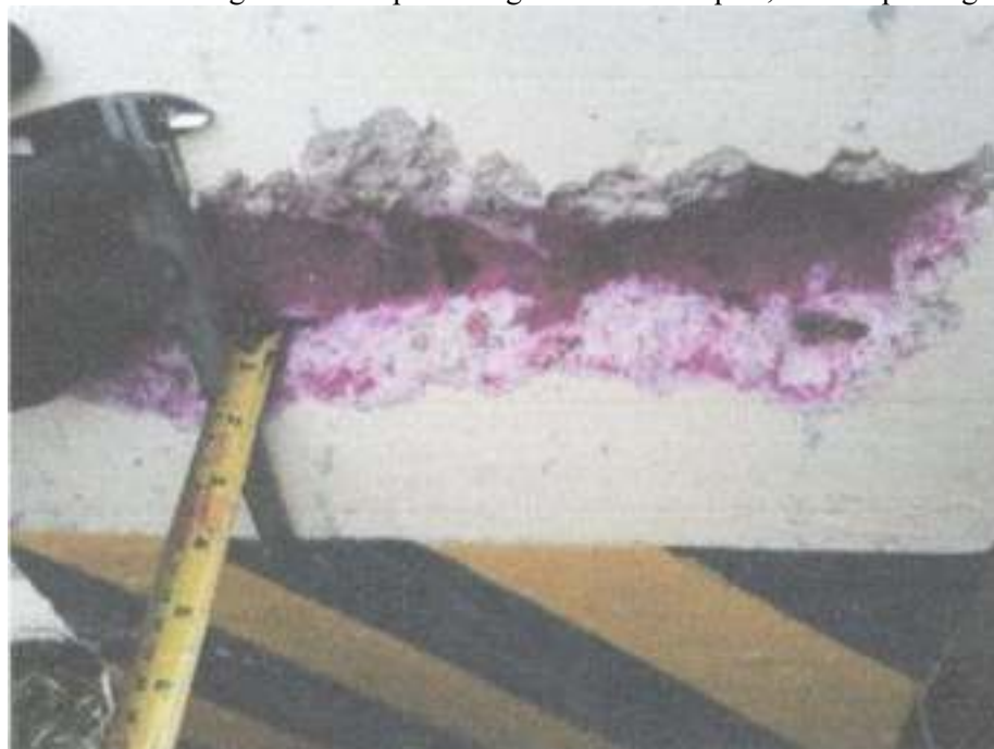
Imagen 12. Regata en columnas para prueba de carbonatación Fuente: Ing. Jessica Ospina – Ing. Fabián Velásquez, estudio patológico
