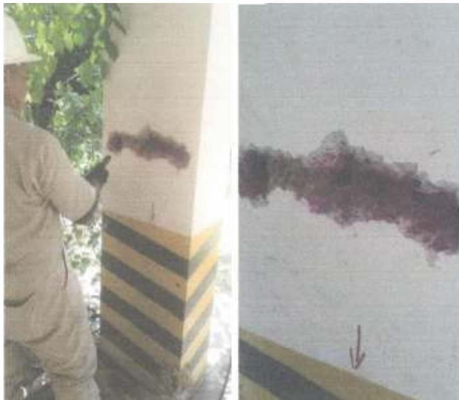
Imagen 12. Regata en columnas para prueba de carbonatación Fuente: Ing. Jessica Ospina – Ing. Fabián Velásquez, estudio patológico
