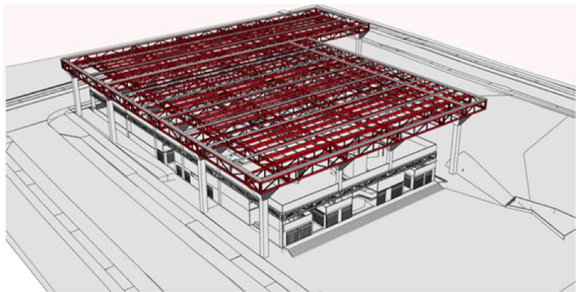
Figura 62. Correas horizontales se asientan ancladas a la cubierta
