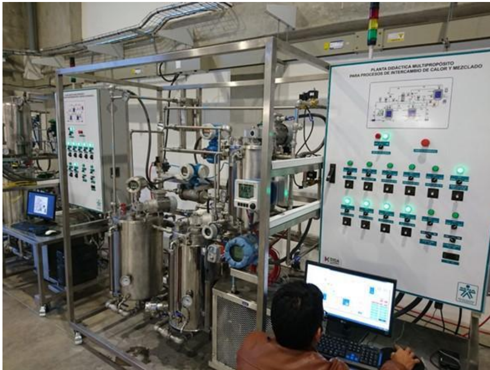
Figura 5. Ilustración de una planta piloto para instrumentación y control de procesos. Adaptado de “Planta piloto y módulos de enseñanza”, por Didacontrol S.A.S, 2018. [6]
