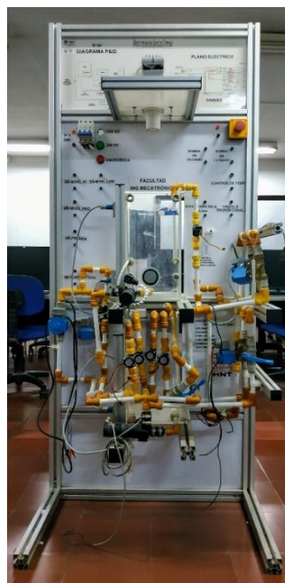
Figura 15. Foto del primer banco de procesos para control de temperatura y flujo de agua desarrollado por la Universidad Santo Tomás. Por el Autor, 2019.
