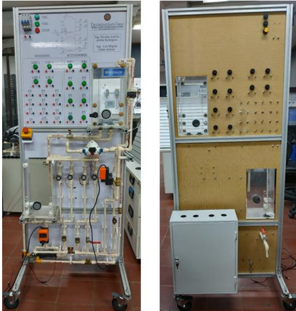
Figura 35. a) Planta de procesos vista frontal. b) Planta de procesos vista posterior. El Autor
