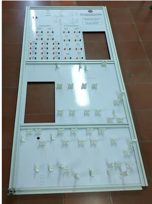
Figura 34. Banco de procesos con la estructura ensamblada y los tableros de MDF acoplados dentro de esta. El Autor
