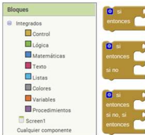
Ilustración 16. Bloques integrados y de control en MIT App inventor.
