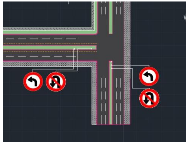
Ilustración 9.17 Instalación de señal giro a la izquierda. Fuente: Elaboración propia.
