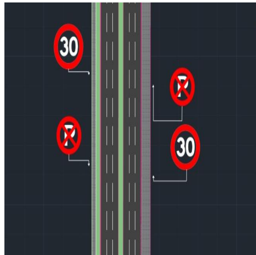
Ilustración 9.19 Instalación de señalización avenida Catama. Fuente: Elaboración propia.
