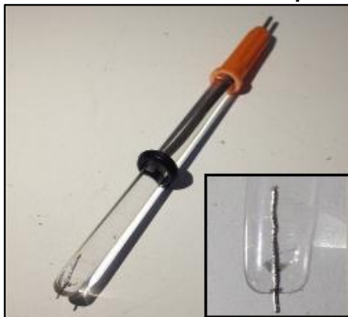
Figura 22. Electrodo de referencia de platino (Pt) 3M
