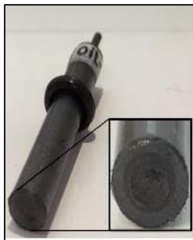
Figura 18. Vista de la superficie del electrodo de trabajo de pasta de carbón
