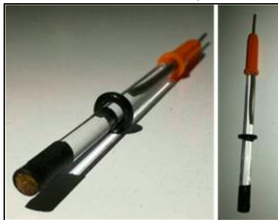
Figura 21. Electrodo de referencia con junta de madera porosa.
