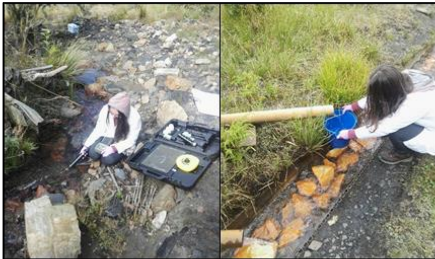
Figura 15. Medición de caudales por método de trazadores y volumétrico
