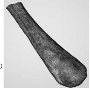
Figura 33. Porción distal obtenida con escaneo 3D Fuente: Autor
