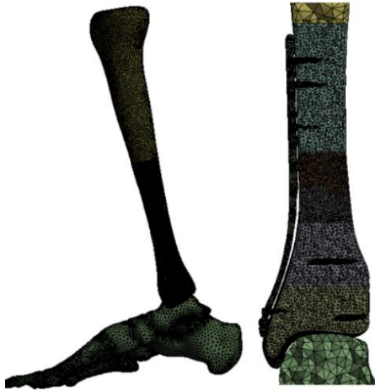
Figura 44. Malla refinada - Fuente: Autor
