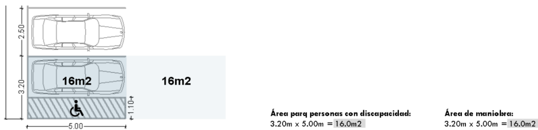
Figura 73. Parqueo de vehículos de personas con discapacidad
