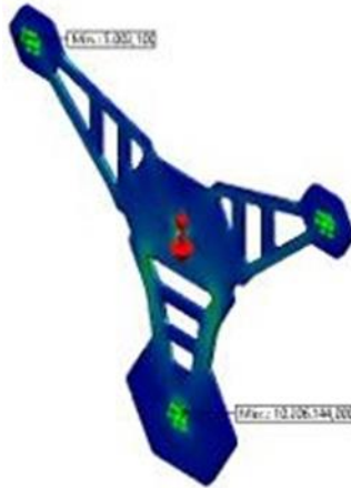
Figura 6.28. Análisis estático por Von Mises
