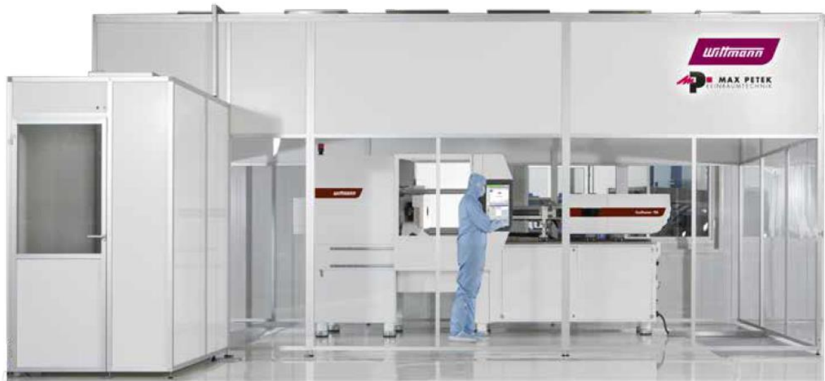
Figura 19. Ejemplo de estructura aislante para prevenir contaminación (Wittmann, 2022a)
