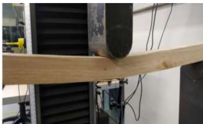
Figura 41. Ensayos mecánicos de la madera (flexión estática). Fuente: Propia
