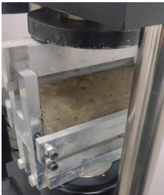
Ilustración 24. Ensayo de tracción CB
