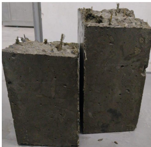
Ilustración 28. Falla de VCB 1 Modulo de rotura
