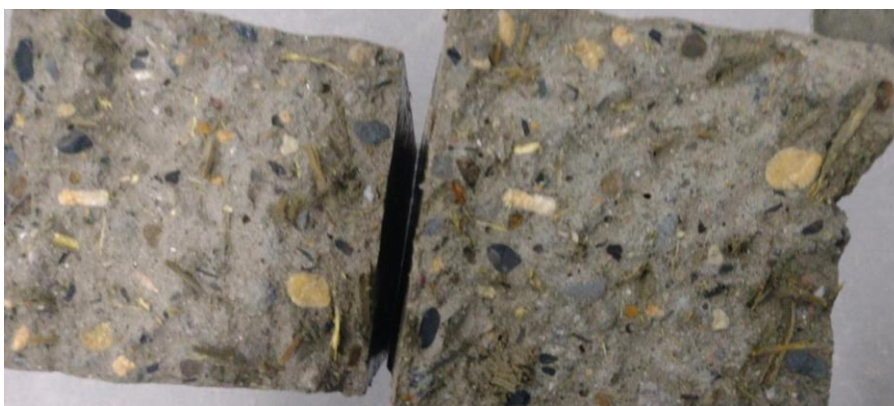
Ilustración 29. Composición interna especimen VCB2 fallado a 28 días
