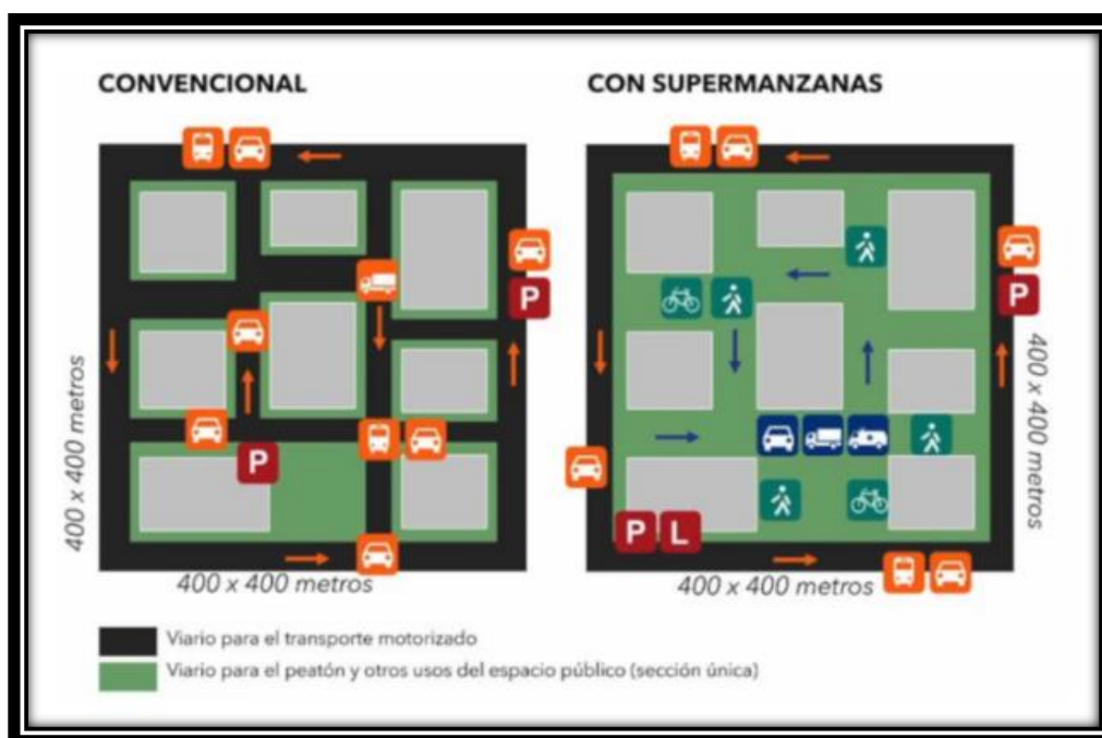
Figura 11. Comparación entre el modelo urbano convencional y el modelo de supermanzanas.
