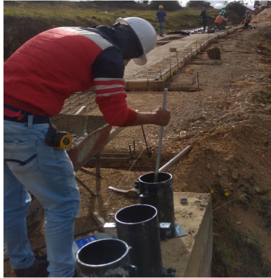
Ilustración 18 toma de cilindros
