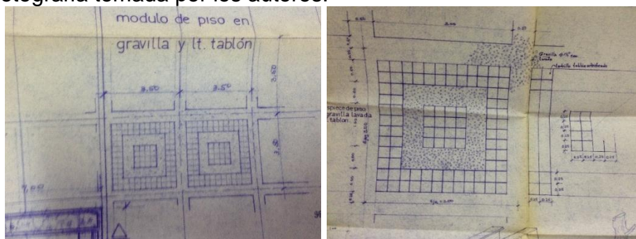
GRÁFICO 12. Detalle de Módulo de piso. Fotografía por los autores.
