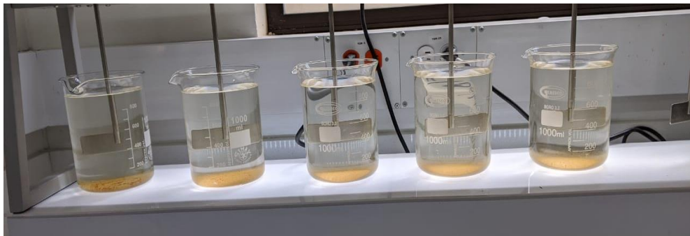
Figura 15. Final del ensayo de jarras. Fuente: Autoría propia, 2020.
