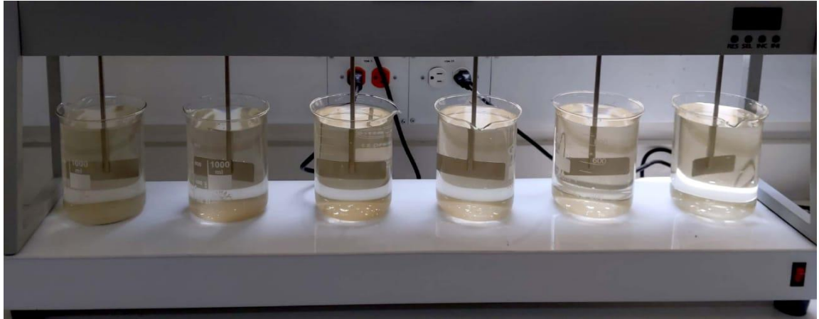
Figura 14. Inicio ensayo de jarras. Fuente: Autoría propia, 2020.
