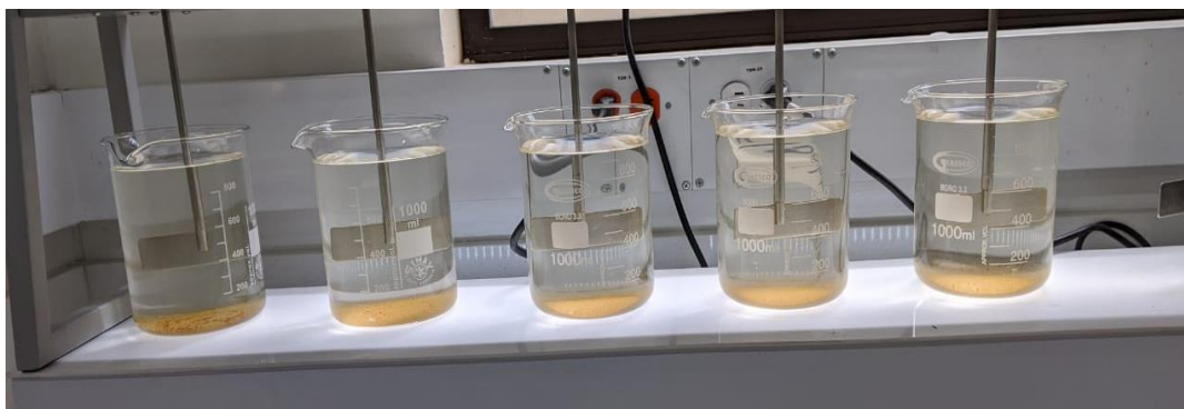
Figura 21. Ensayo de Jarras final. Fuente: Autoría propia, 2020.
