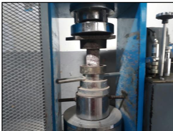
Figura 12. Ensayo de resistencia a la compresión de los núcleos de concreto Fuente: Los autores.
