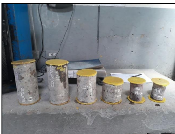
Figura 11. Los núcleos extraídos son capinados y cortados cumpliendo la relación diámetro altura. Fuente: Los autores.
