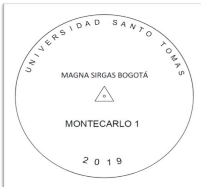
Figura 8 Nomenclatura de un mojón
