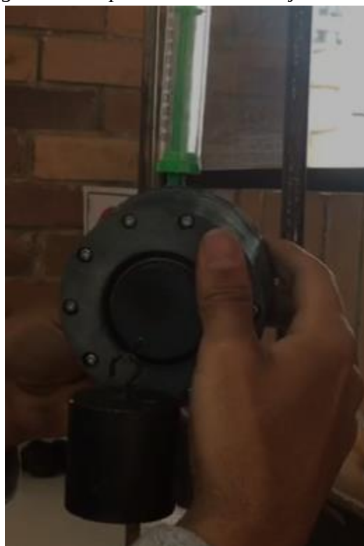
Imagen 54: Acople eje de salida - masa de 500 g
