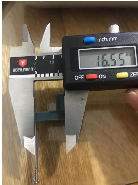
Imagen 50: Radio entre el centro del eje entrada y la puntilla
