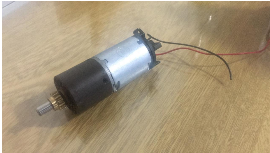
Imagen 5: Motor eléctrico para el motorreductor.
