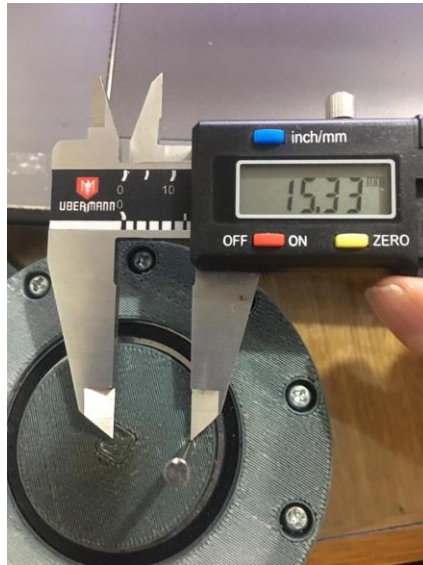
Imagen 51: Radio entre el centro del eje salida y la puntilla que sostiene el peso.
