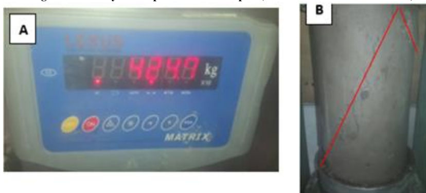
Fotografía 20. Ensayo a compresión Probeta 1 piso (Lab. Universidad Santo Tomás)
