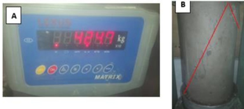
Fotografía 27. Ensayo a compresión Probeta 1 piso (Lab. Universidad Santo Tomás)
