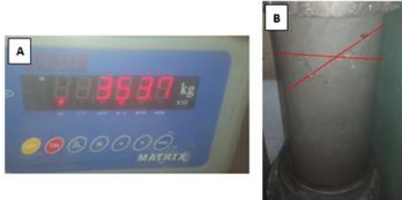
Fotografía 26. Ensayo a compresión Probeta 2 piso (Lab. Universidad Santo Tomás)
