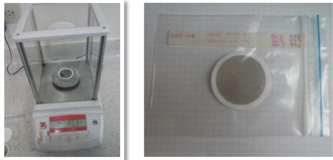
Figura 9. Pesaje final del filtro expuesto y almacenamiento para análisis
