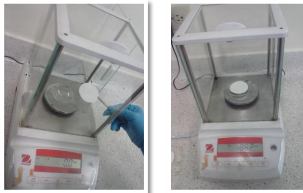
Figura 8. Acondicionamiento del pesaje inicial del filtro
