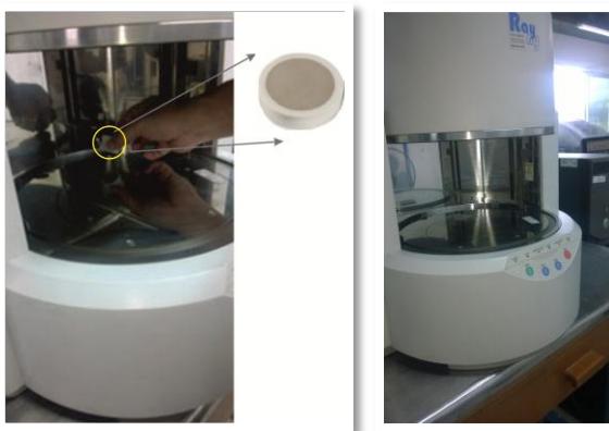
Figura 11. Preparación de la muestra para análisis de fluorescencia de Rayos-X
