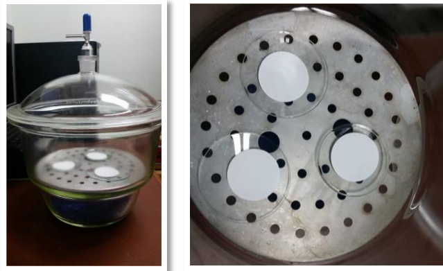
Figura 7. Acondicionamiento de filtros limpios en el desecador
