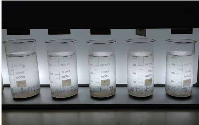
Figura 20. Proceso de sedimentación luego del uso la dosis requerida del coagulante Sulfato de Aluminio.
