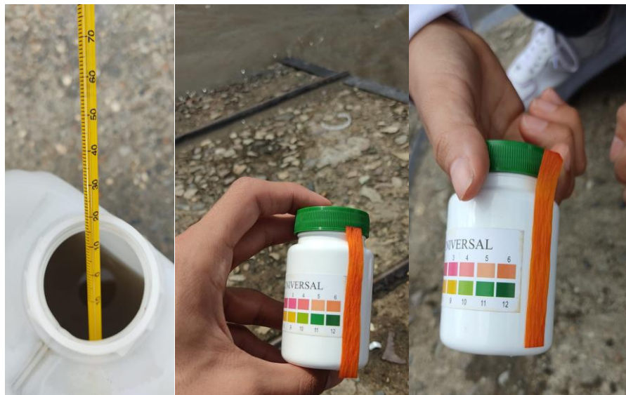
Figura 3. Toma de temperatura y pH en el punto de captación
