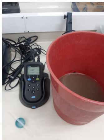
Figura 10. Ajuste de pH de muestra de agua cruda de río
