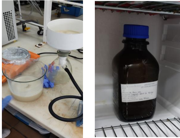
Figura 8. Filtración del coagulante y refrigeración.
