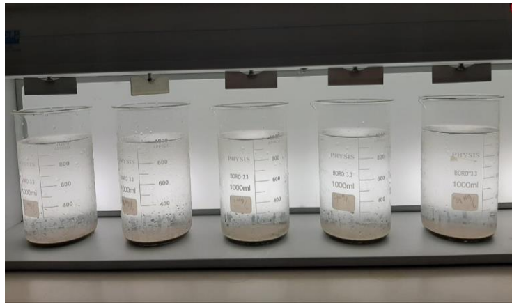
Figura 19. Proceso de sedimentación luego del uso la dosis requerida del coagulante de Moringa
