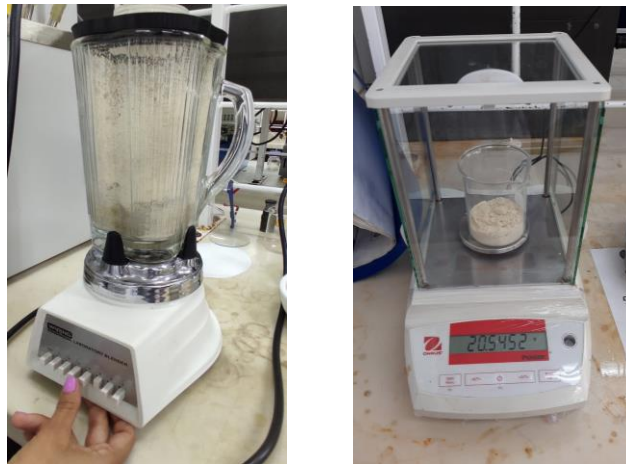
Figura 6. Proceso de trituración de la materia prima y pesado del polvo
