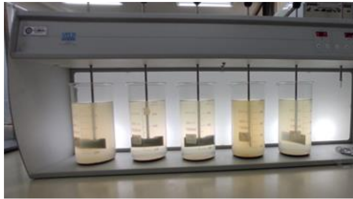
Figura 12. Proceso de sedimentación en vasos de precipitado
