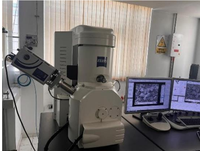
Figura 19. Equipo microscopia electrónica de barrido
