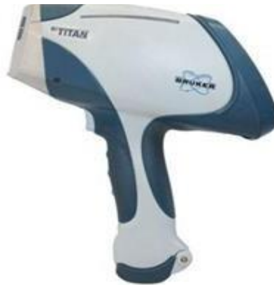
Figura 17. Equipo de FRX portátil S TITAN 500 marca BRUKER
