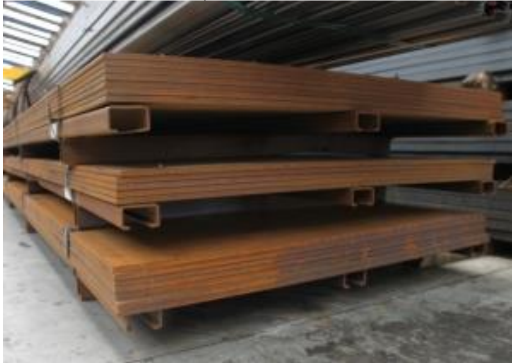
Fotografía 4. Placa o planchas de acero A36, laminados en caliente con un espesor de 1/4 "a 1"
