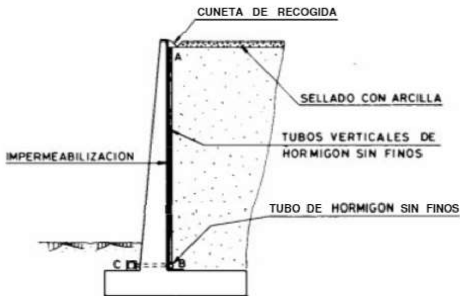
Figura 14. Detalle general de drenajes
