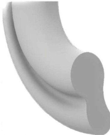
Figura 6 Primera propuesta de geometría para el cuadrante circular
