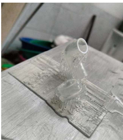
Figura 27 Piezas en proceso de fabricación mediante impresión 3D
