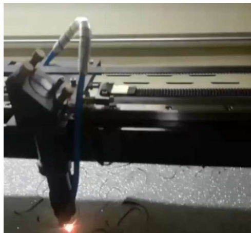
Figura 23 Proceso de corte laser de las piezas en acrílico
