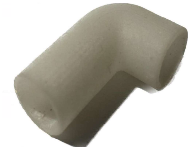
Figura 28 Pieza de acople para el desagüe del fluido en impresión 3D
