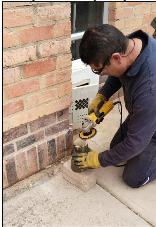
Figura 12. Afinado de los extremos en probetas de compresión paralela.
