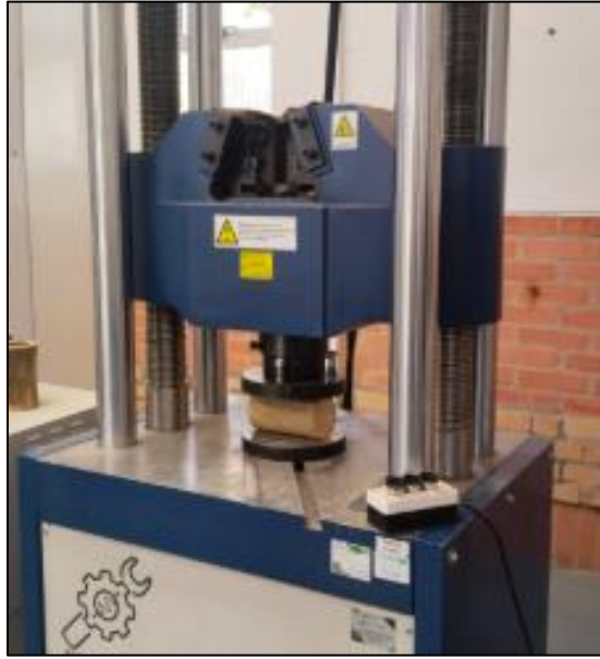
Figura 17. Montaje ensayo compresión paralela
