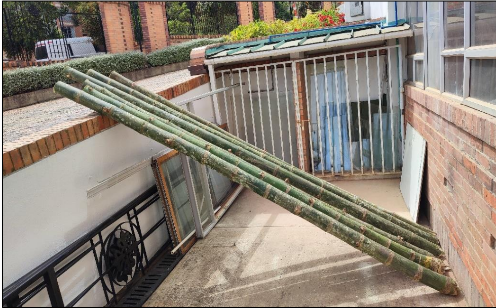
Figura 7. Secado de los culmos al aire libre
