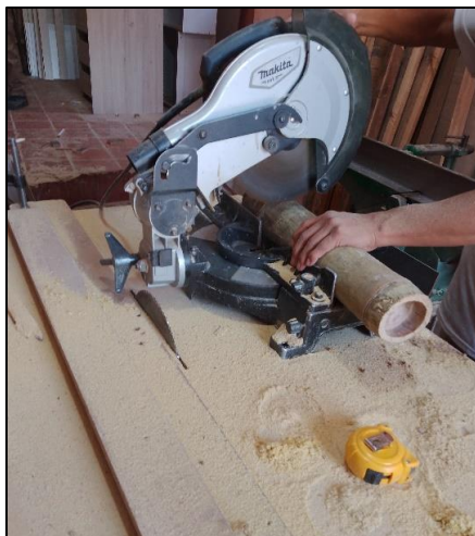
Figura 11. Corte de las probetas por medio de sierra de disco
