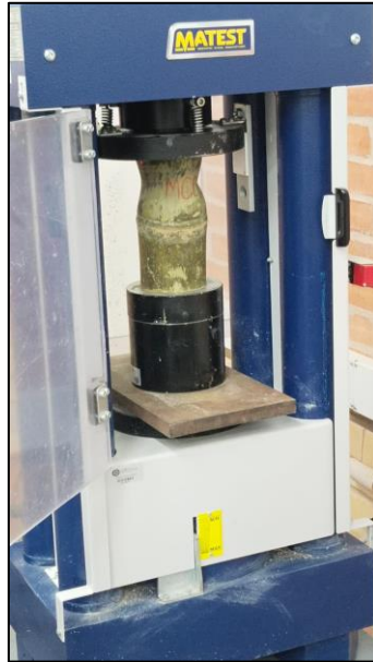
Figura 16. Montaje ensayo compresión paralela
